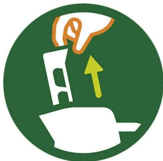
Um filtro de microrede amovível no bico recolhe partículas minúsculas de calcário, com dimensões de até 200 micron, garantindo a boa qualidade do chá.
